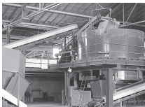
Par la suite, celui-ci est broyé et préparé dans des broyeurs à meule.
