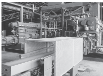
Le matériau est poussé par une boudineuse dans une vis sans fin, il est là pressé et coupé.
